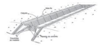
Silo Trincheira com uma rampa
