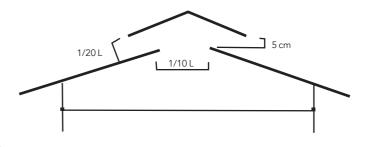
Abertura com 10% da largura e sobreposição de telhado com 5% (da largura)
