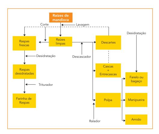
Figura 1 – Obtenção dos subprodutos a partir das raízes de mandioca
